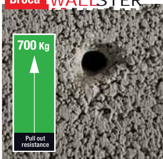
Tests realizados con un taladro SDS-plus GBH 2 con percusión en un bloque de hormigón hueco con una fijación química
