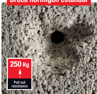
Tests realizados con un taladro SDS-plus GBH 2 con percusión en un bloque de hormigón hueco con una fijación química
